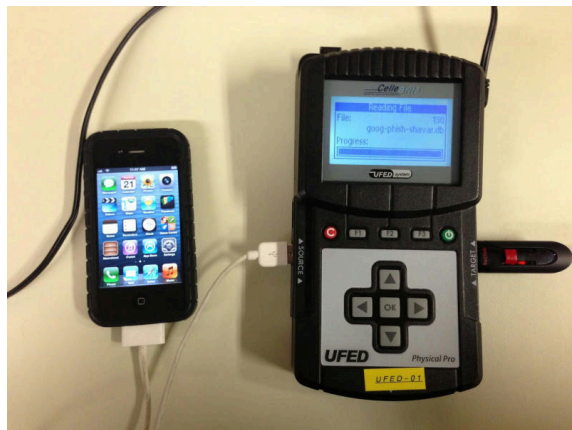
Un Cellebrite Universal Forensics Extraction Device (UFED) qui extrait les données d'un iPhone 4S, 2013.
