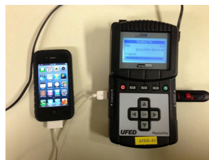
Un Cellebrite Universal Forensics Extraction Device (UFED) qui extrait les données d'un iPhone 4S, 2013.
