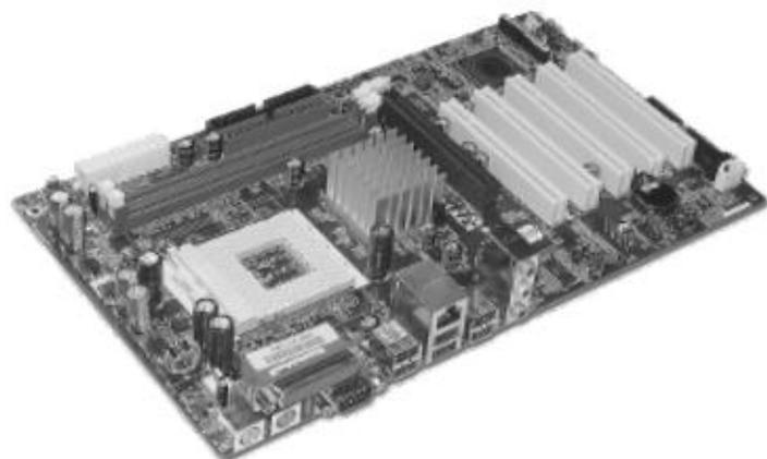
vengono attaccati almeno un processore, della RAM, un dispositivo di stoccaggio (hard-disk o un altro tipo di memoria), ciò che fa avviare il computer (il firmware), altre schede e periferiche, a seconda dei bisogni.
