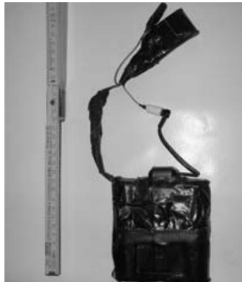
GPS-Sender vom BKA (2007), GPS-Antenne separat
